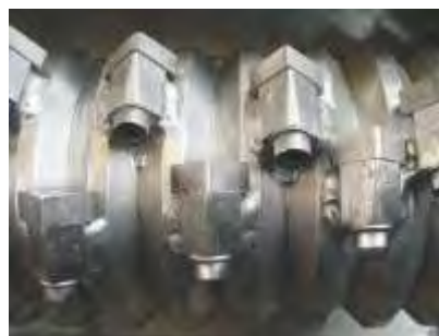
Profilrotor mit geschweißten Messertägern (GAZ 62 G)
