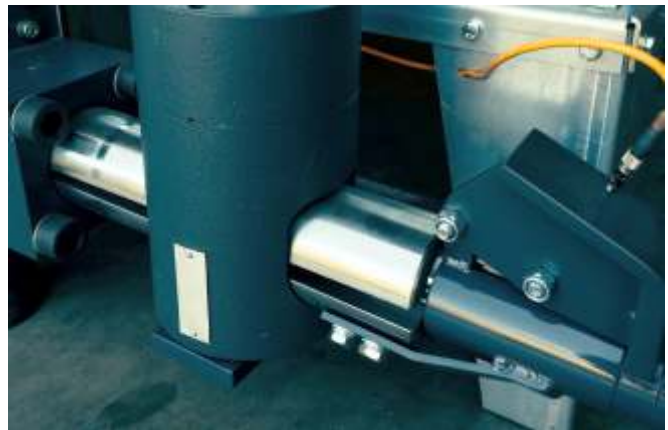
Zangenzylinder Gripper cylinder
