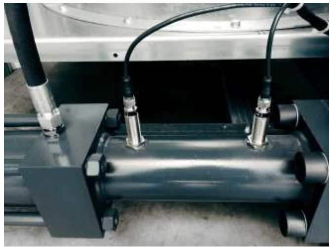
Zylinderüberwachung mit Sensoren Cylinder monitoring with sensors
