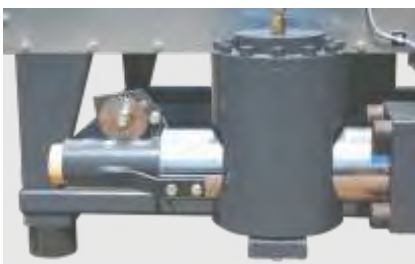
Stranglängenüberwachung zur automatischen Brikettierlängenregulierung
