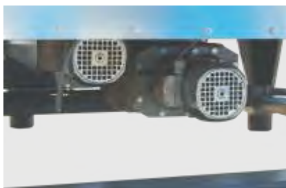
Starke Getriebemotoren für Schnecken- vorverdichtung und Rührwerk
