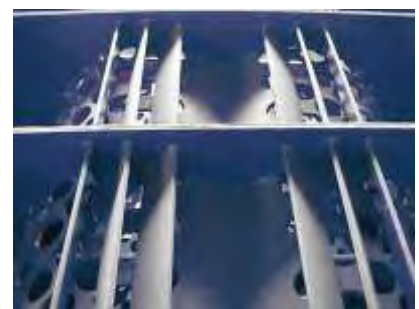
Sieb mit Nachbrecherleisten
